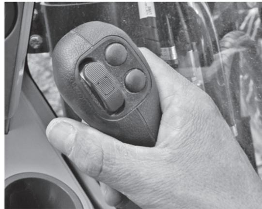
図-6 モジュレーションスイッチ付き操作レバー
