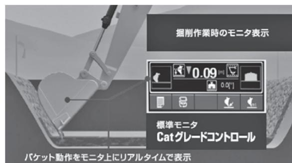
図-2 油圧ショベル マシンガイダンスシステム
