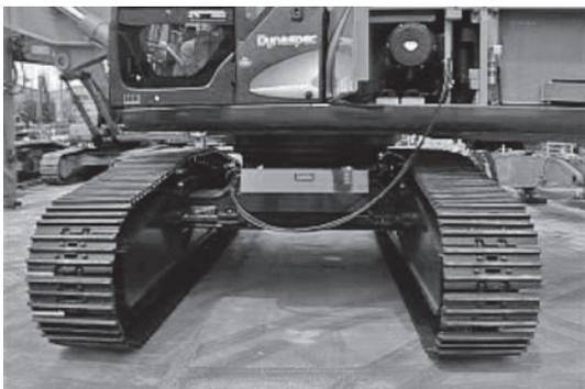
写真-7 油圧拡幅式クローラ
