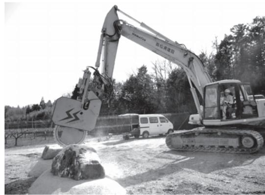
写真一6 バックホウに取り付けた開発中の試作機
