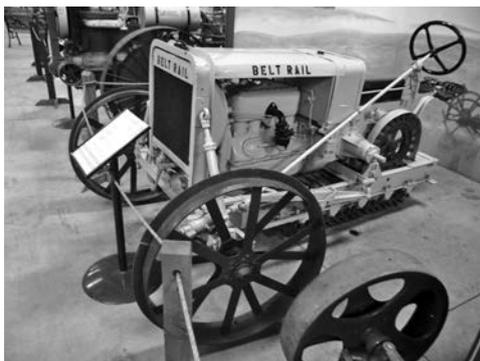
写真一10 ベルトレール社B型トラクタ, 15kW ガソリンエンジン (1918年製)
