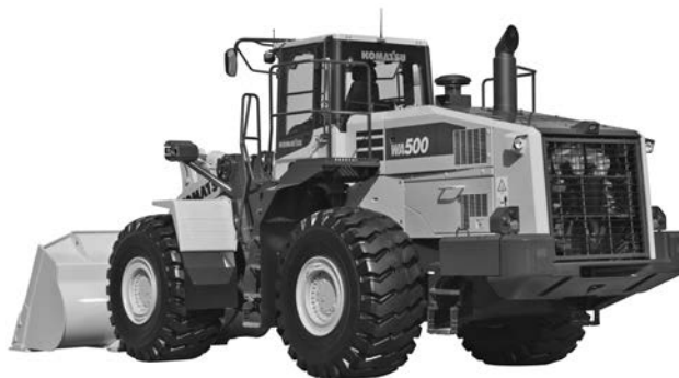
写真-5 コマツ WA500-7 ホイールローダ (一部オプションが含まれる)
