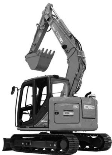
写真一2 コベルコ建機 SK75SR-3 油圧ショベル（後方超小旋回型）
