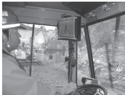
写真九 転圧管理システム
