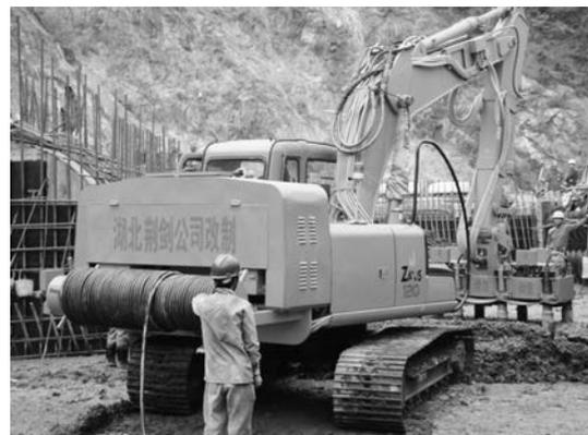
写真一六 中国電動式バイバック
