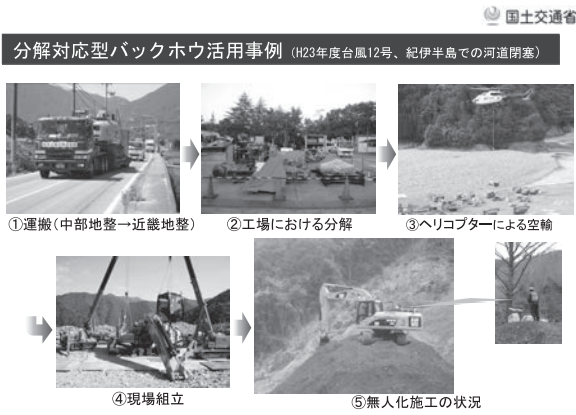
図一45 国土交通省で保有する無人化施工機械（活用事例）
