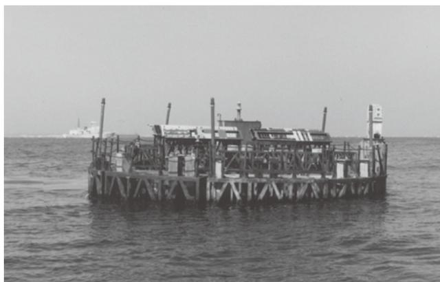
写真一 1 コンクリート暴露試験 東京湾海上において1973年から8年間試験実施
