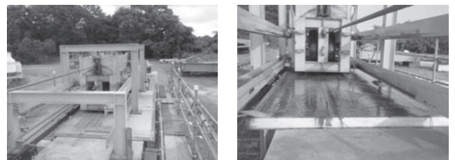
写真—6 輪荷重疲労試験状況
