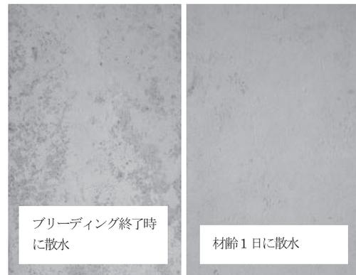
写真—1 湛水（散水）時期によるコンクリート表面の美観の違い
