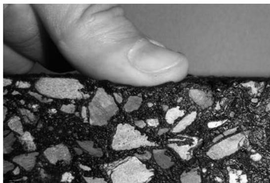
写真—1 「本舗装」の構造
