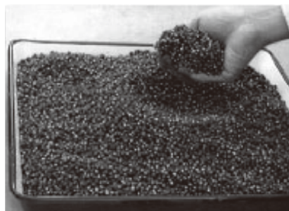
写真-1 発泡ビーズ混合軽量土工法
