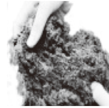
写真—4 短繊維混合補強土工法
