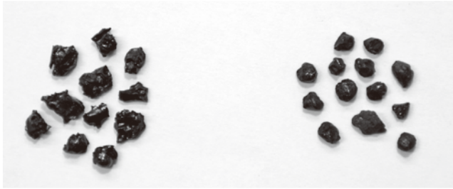
(左：磨砕なし，右：磨砕処理後) 写真—2 銅スラグ細骨材の粒子形状
