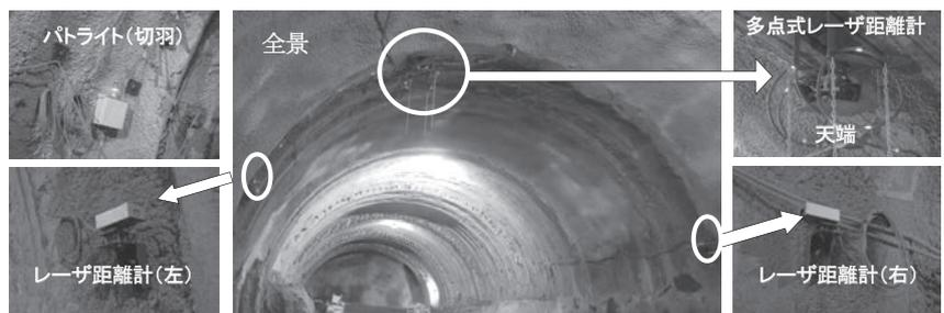
写真-1 切羽崩落予知システム
