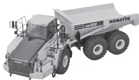
写真一 4 コマツ HM400-3 アーティキュレートダンプトラック
