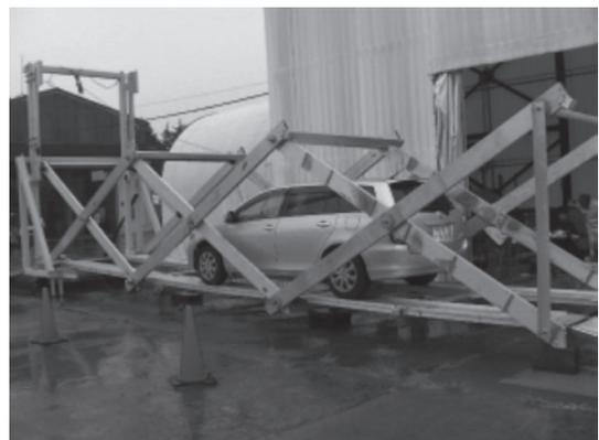
写真一六 公開前の各車種による車両積載実験
