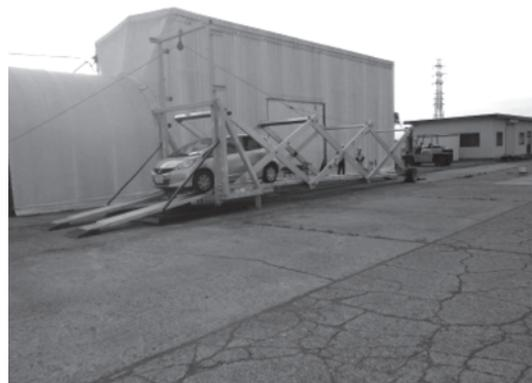
写真一9 シンガーズ展開と同時に床版も展開され、その後車両走行
