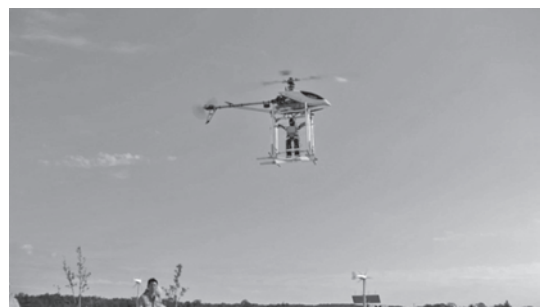
写真一14 二足歩行ロボット(CALI-BO)を空輸している無人飛行体(SARA-HV)
