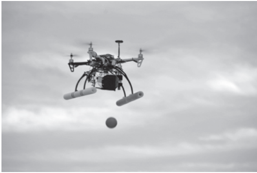
写真一20 消火ボールを積載した無人飛行体 (SARA-XVF)
