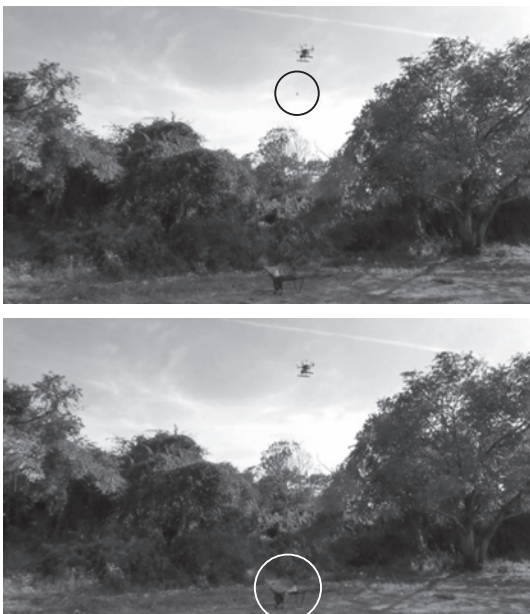
写真一21 無人飛行体(SARA-XVF)が投下した(上図)消火ボールが鎮火する様子(下図)
