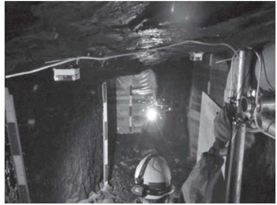
写真一22 亜炭鉱内(地下)で安定飛行した無人飛行体(SARA-XVU)
