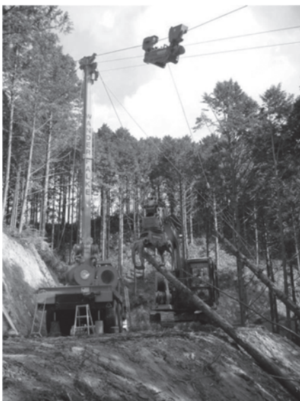
写真-4 タワーヤーダ (林野庁ホームページより)
