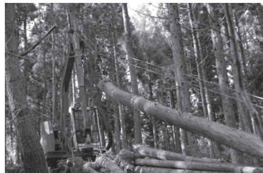
写真-5 スイングヤーダとアーム先端にプロセッサ作業機を持つ機械
