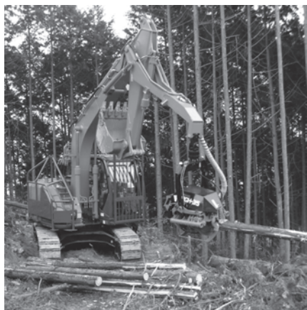
写真一六 土工用とプロセッサ用のアームを持つ機械
