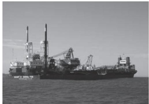
写真—12 半潜水台船による浚渫船団搬入
