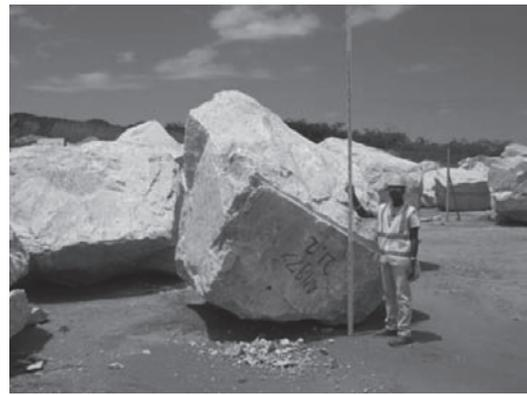
写真一六 最大クラスの石材である Class I Armour Stone (11 t ～ 22 t, 写真は約 21 t)
