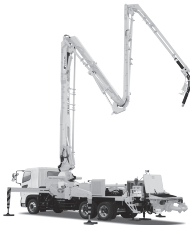
写真一 3 極東開発工業 PY120-30 コンクリートポンプ車
