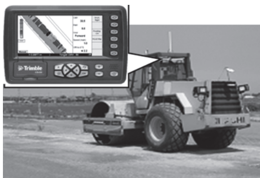
図-3 TS・GNSS による締固め管理技術
