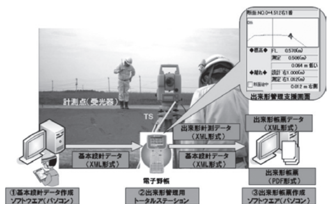
図一 1 TS による出来形管理技術（土工）
