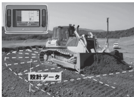
図-4 MC/MG (ブルドーザ) 技術
