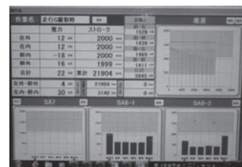
写真一一 左:防塵・防滴・耐衝撃型 PC (パソコン), 右:画面表示例 (ジャッキ推力, 支点反力)
