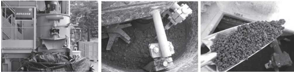
写真—4 濃縮残渣(脱水ケーキ)の粒状化
