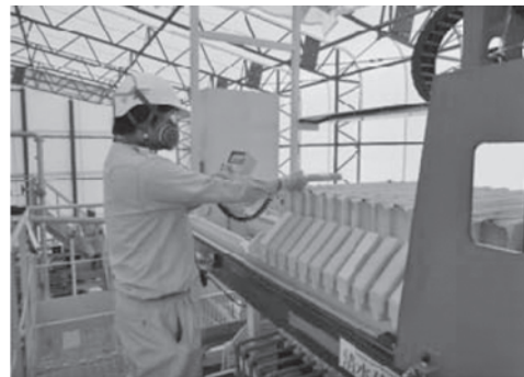
写真一五 フィルタープレス近傍の空間線量率の測定
