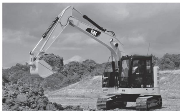
写真—1 キャタピラージャパン Cat 314E CR 後方超小旋回型油圧ショベル
