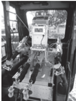
写真—1 遠隔操縦用建設ロボット（国土交通省，株式会社フジタ）
