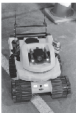
写真—4 消防用偵察ロボット FRIGO-M（三菱特機システム株式会社，総務省）
