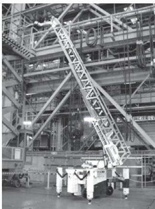
写真—9 狹隘部遠隔重量物荷揚／作業台車 (三菱重工業株)
