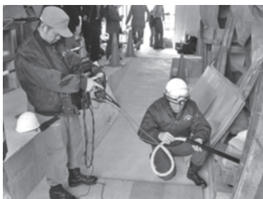
写真—3 能動スコープカメラ（東北大学，国際レスキューシステム研究機構）
