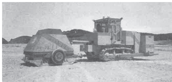
図一 2 1990 年に開発された巨大振動プレート 5)
