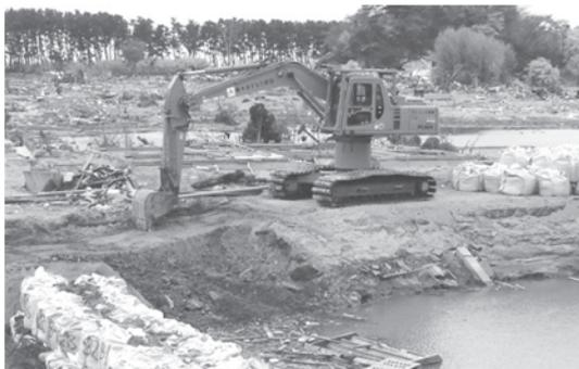
写真— 11 水陸両用バックホウ 0.8m<sup>3</sup> 級
