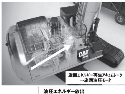
図-3 旋回加速時のエネルギー放出
