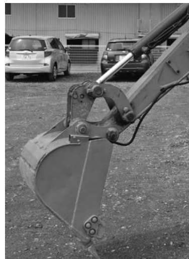
写真一六 バケット傾斜センサ取付状況
