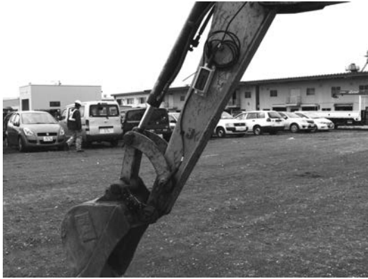
写真—11 アームに取付けられたレーザ受光器
