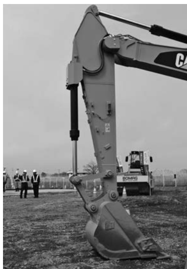
写真—8 バケット屈折角検出用シリンダリニアセンサ
