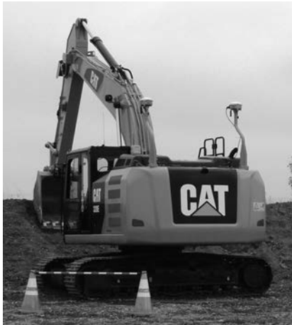
写真一四 メイン受信アンテナとサブ受信アンテナ
