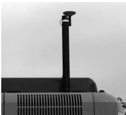
写真一五 ジャイロコンパスポールと測位用受信アンテナ
