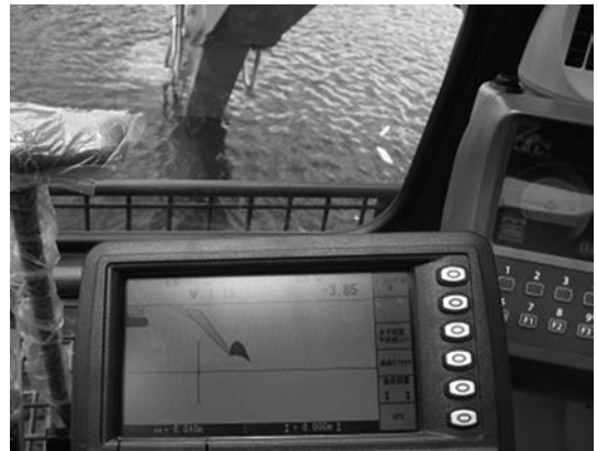
写真一三 バケット水没状態とモニタ画面
