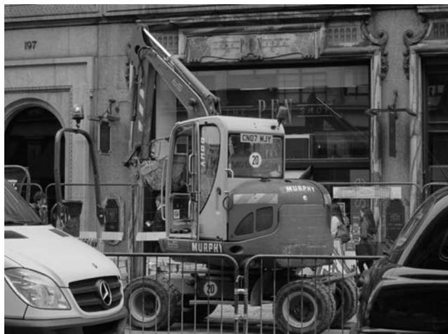
写真—4 リージェント通りで道路工事中の車輪式ミニ油圧ショベル
