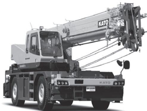
写真一六 加藤製作所 SR-250Ri PREMIUM ラフテレーンクレーン
