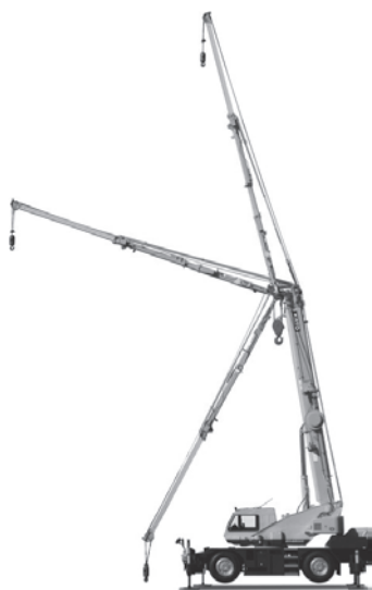
写真一五 加藤製作所 SR-250Ri PREMIUM 2 段ジブの空中振り出し
