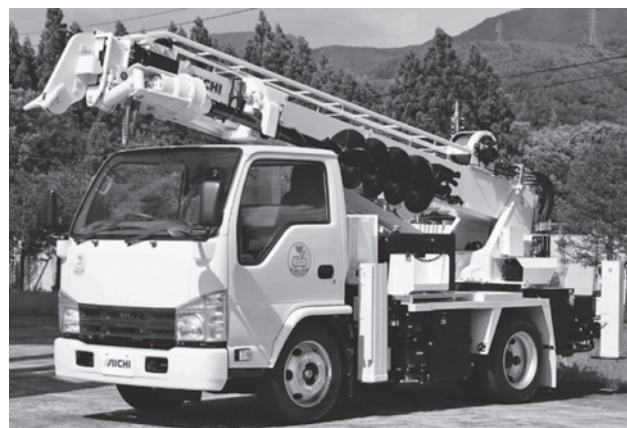
写真一七 アイチコーポレーション D50A ハイブリッド式穴掘建柱車
