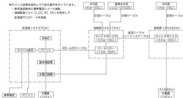
図—5 地下水位計測システムフロー
