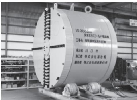
写真一五 φ 3000 mm 用泥水式掘進機
