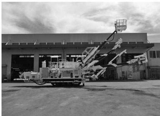
写真—1 小断面クローラ式エレクター付吹付け機(第3次排出ガス対応型)
