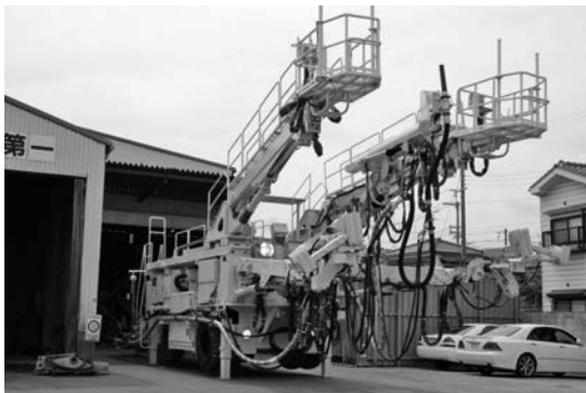
写真一３ タイヤ式エレクター付吹付け機（第3次排出ガス対応型）
