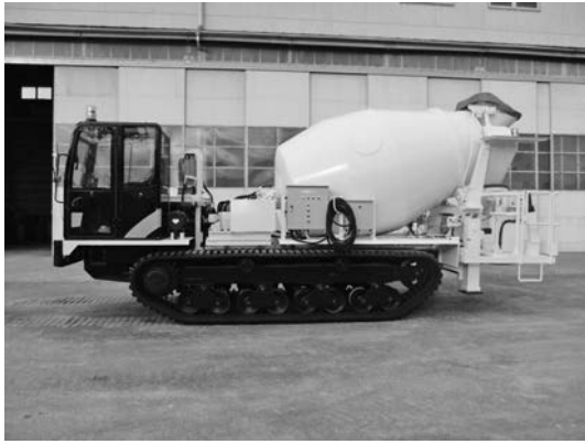
写真一２ ゴムクローラ式ミキサー車（第2次排出ガス対応型） 最大積載量 4.5 m 3 悪条件の路盤を克服
