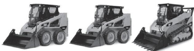
写真-3 キャタピラージャパン Cat 216B<sub>3</sub>/Cat 226B<sub>3</sub> スキッドステアローダ Cat 259B<sub>3</sub> コンパクトトラックローダ
