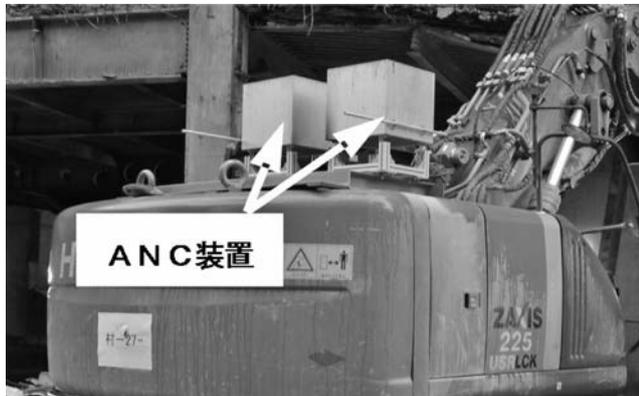
写真—5 ANC 装置の装着状況
