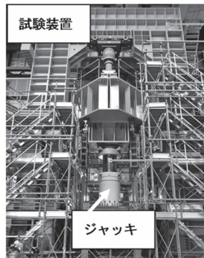
写真-2 ジャッキ性能評価試験
