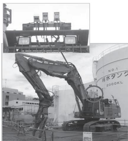
図一六 作業用車載カメラ
