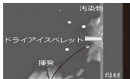
図一 2 ドライアイスブラストの原理
