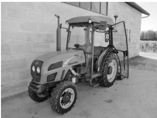
写真一九 葡萄畑仕様の狭軌トラクタ（前側面）
