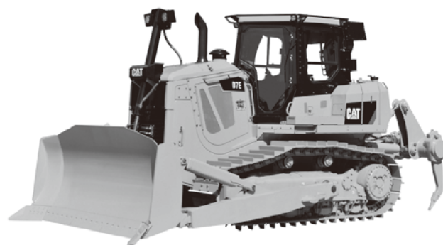
写真一 1 キャタピラージャパン Cat D7E エレクトリックブルドーザ
