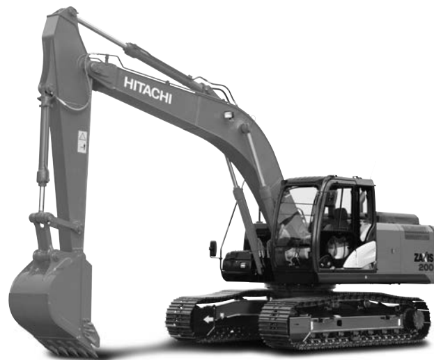
写真—4 日立建機 ZX200-5B 油圧ショベル
