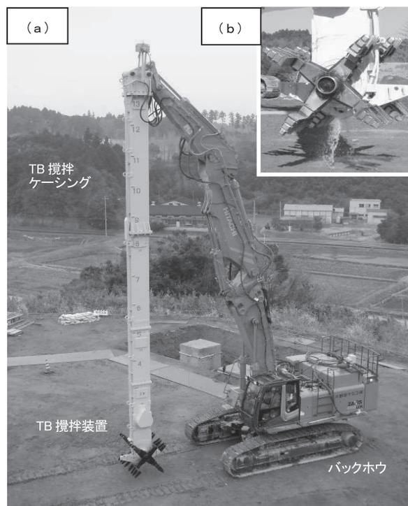
写真—1 本工法施工機全景
