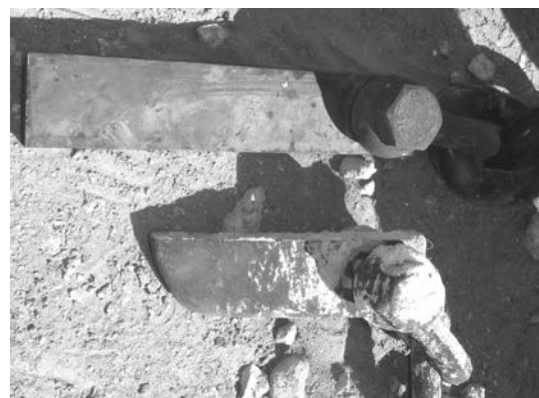
写真一 5 チェーン先端のブレード摩耗
