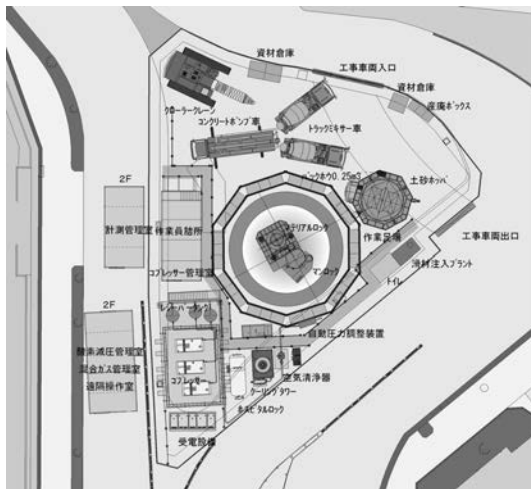
図-4 コンクリート打設時の設備配置図
