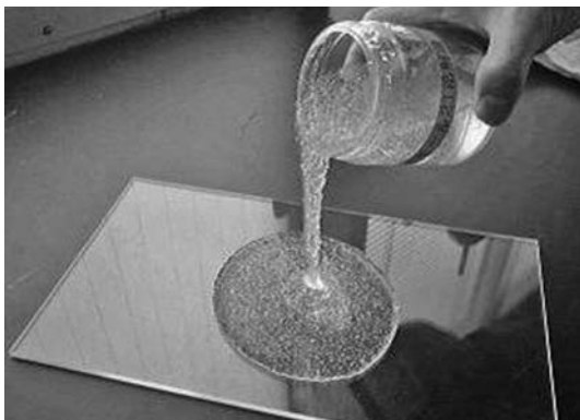
写真一七 沈下促進材
