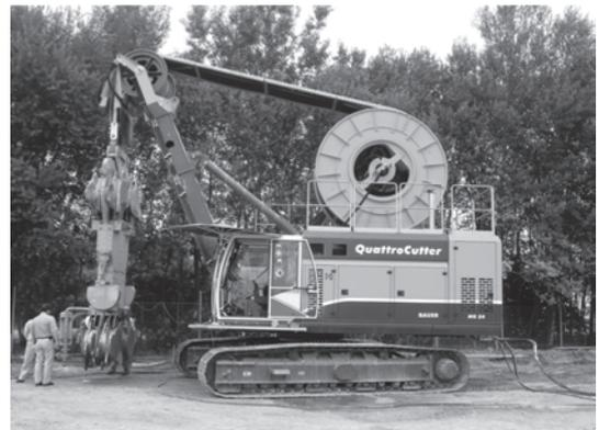
写真一 2 BCM5 型 本施工機 (クアトロカッター)
