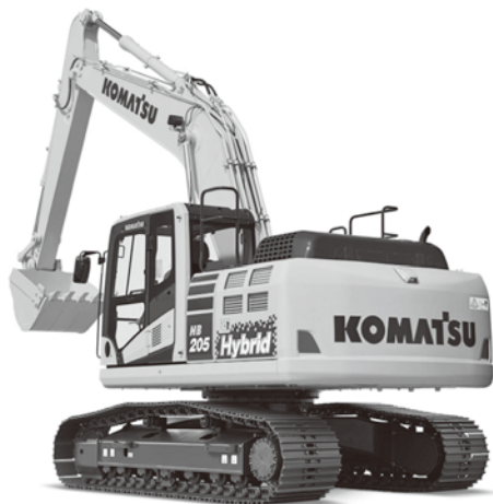
写真一 1 コマツ HB205-2 ハイブリッド油圧ショベル (一部オプションが含まれる)
