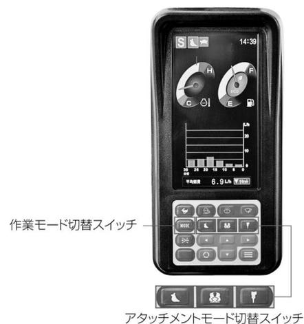
図二 作業モード切替スイッチとアタッチメントモード切替スイッチ
