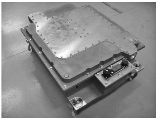
写真一4 キャパシタモジュール
