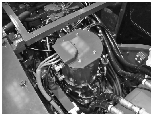
写真—2 電動旋回装置
