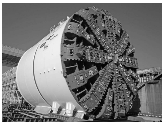
写真－3 工場仮組立完成状況
