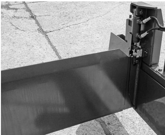
写真一四 伸縮モールドボード油圧上下機構
